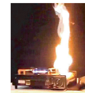
カセットボンベを正しく装着しなかつたため、漏れたガスが引火したため、燃焼した。【再現実験】
