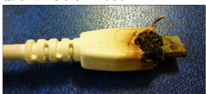
内部が変形したコネクターを使い続けたために温度が上昇し、発煙(上) 焦げたコネクター(下)
