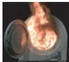
洗濯槽の中で、自然発火して燃えるタオル【再現実験】
